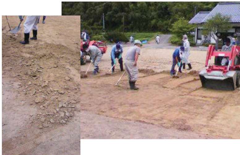
図 1-22 福島県伊達市霊山町小国での土壌の除染試験 伊達市霊山町小国の公民館の広場の土壌に対して、ポリイオン複合体を用いて除染試験を行ったときの様子です。
