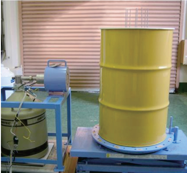
図13-28 模擬ウラン廃棄物の \gamma 線測定試験 廃棄物の密度分布が不均一でウラン線源の分布も不均一な模擬廃棄物を製作し、廃棄物収納容器の外部での \gamma 線測定を実施しました。 \gamma 線エネルギーは766 KeVと1001 KeVを選択し、それぞれのエネルギーでの \gamma 線計数率を計算しました。
