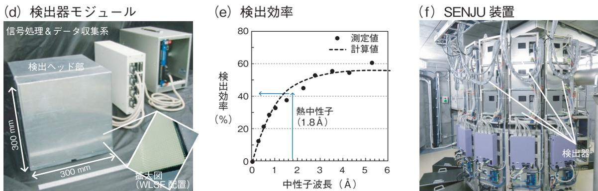
図13-12 大面積2次元シンチレータ中性子検出器 (SENJU装置用)
