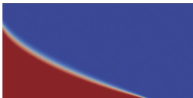
図3-5 塩水楔試験解析結果の例(塩濃度分布)
