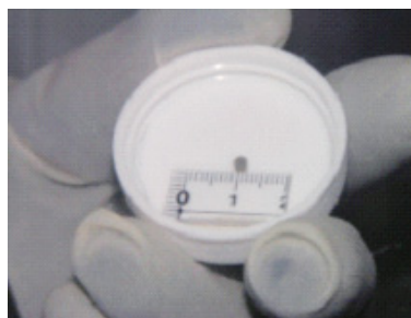
図 8-11 (\text{Zr}_{0.58}\text{Pu}_{0.21}\text{Am}_{0.21})\text{N} 焼結体 グローブボックス内で撮影した直径約 3 mm の高密度焼結体です。
