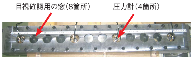
図 3-9 平行平板試験装置（上方から撮影）
