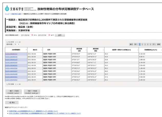
図1-8 放射性物質の分布状況等調査データベース 空間線量率や核種濃度に関する定量的な値を提供することで、解析を支援します。(http://radb.jaea.go.jp)
