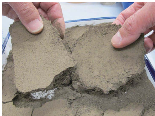
図 1-20 固化土壌片 畑土壌にポリイオン複合体を散布したあとに、乾燥・固化させた土壌片です。
