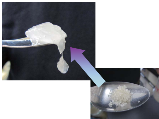
図 1-20 固化土壌片 畑土壌にポリイオン複合体を散布したあとに、乾燥・固化させた土壌片です。
