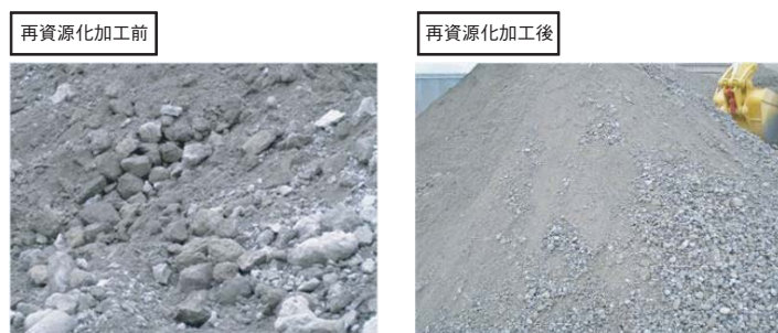
図13-7 再資源化加工を行ったコンクリート
