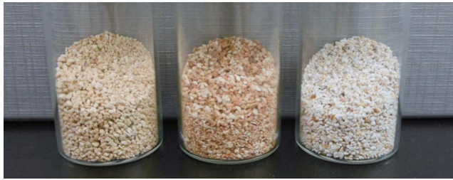
図1-48 実験に用いたゼオライト吸着剤 水素発生量の測定に用いた三種類のゼオライト吸着剤(左から、ゼオライトH、ゼオライトEH、モルデナイト)の外観を示します。
