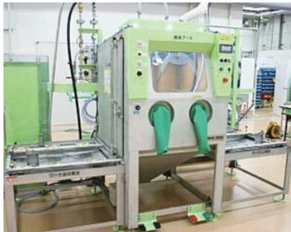
図13-1 ウェットブラスト除染装置（手動タイプ） 除染ブース、ブラスト材回収器、排水処理装置、排気装置、 空気圧縮機から構成し、ブース内でブラストガンにより 除染を行います。
