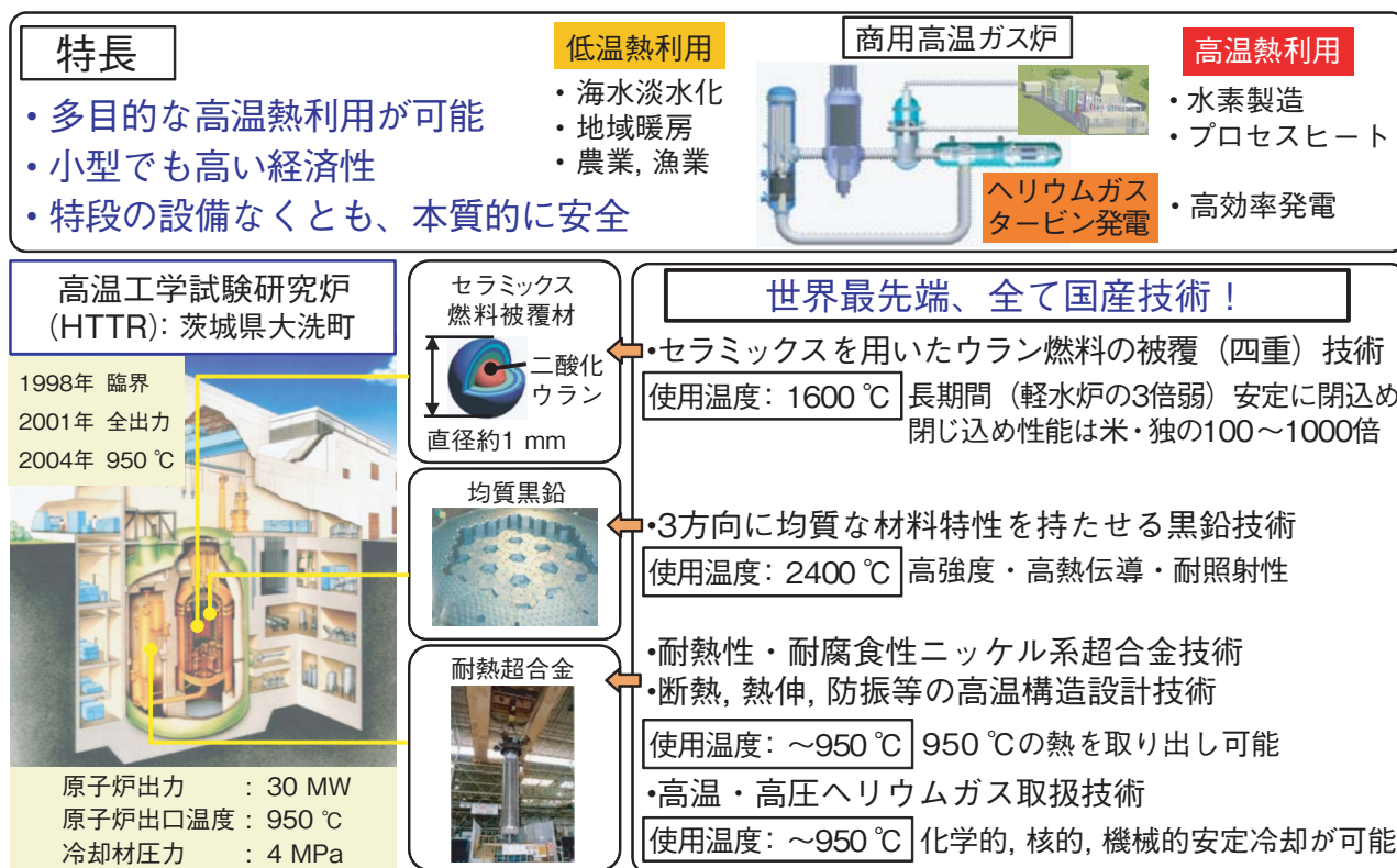
図 9-1 高温ガス炉の概要：特長、利用、HTTRの主要仕様及び主要技術
