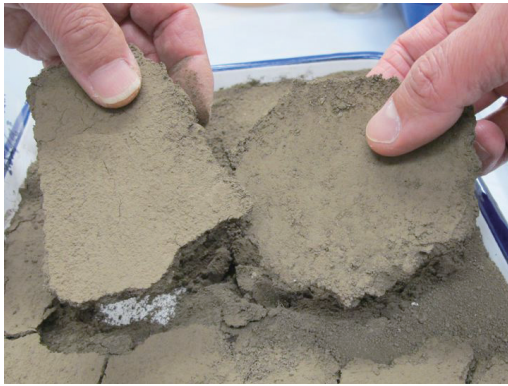
図 1-20 固化土壌片 畑土壌にポリイオン複合体を散布したあとに、乾燥・固化させた土壌片です。
