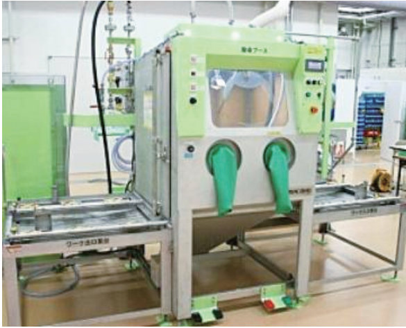
図13-1 ウェットブラスト除染装置（手動タイプ） 除染ブース、ブラスト材回収器、排水処理装置、排気装置、 空気圧縮機から構成し、ブース内でブラストガンにより 除染を行います。
