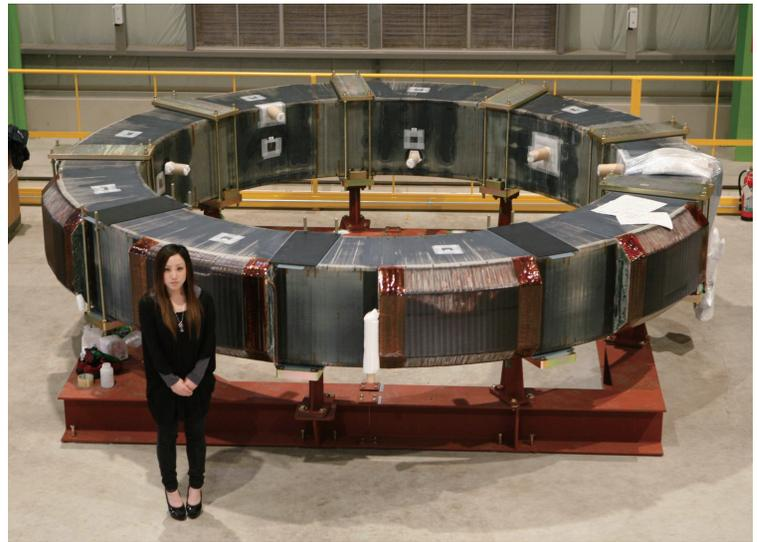
トカマク型核融合炉の成立条件のひとつとして、高温高密度のプラズマを長い間閉じ込めておく必要のあることが挙げられます。そこで、プラズマを制御するために使用するコイルを超伝導化することが必須となります。将来の核融合炉を目指した実験を行う装置JT-60SAでは、超伝導コイルを日欧で協力して設計・製作しており、中心ソレノイド (CS) と平衡磁場 (EF) コイルからなるポロイダル磁場 (PF) コイルシステムについて、日本が設計・製造を担当しています (図 4-17)。これらのコイルは、超伝導導体を平板状に巻いたパンケーキコイル (図 4-18) を複数層重ね、パンケーキコイル同士を電気的に接続することで一体のコイルに仕上げます。最初に製作している EF 4 コイルは、二層パンケーキ (ダブルパンケーキ: DP) コイルを一単位として製作し、この DP コイルを10枚重ねて完成させます。
