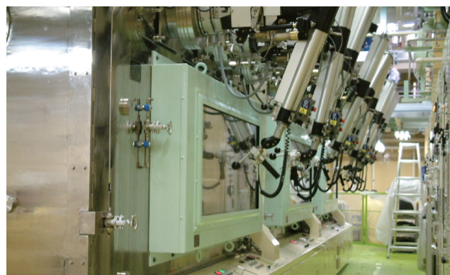
図8-3 NUCEF施設に設置したTRU高温化学モジュール放射能の高い超ウラン元素（TRU）試料を不活性雰囲気中で取り扱える世界でも数少ない施設で、様々な基礎的なデータを取得しています。
