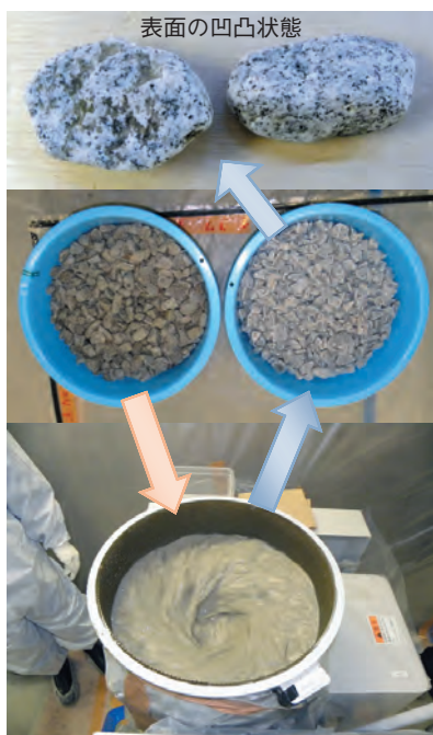
図1-8 摩砕方式による除染試験 渦巻き状の水流で砂利の表面が削れる汎用のバレル研磨機を使い、1バッチ当たり砂利: 20 kg, 水: 20 ℓ, 回転数: 150 rpm 及び研削時間: 20 ~ 60 分で試験を実施しました。
