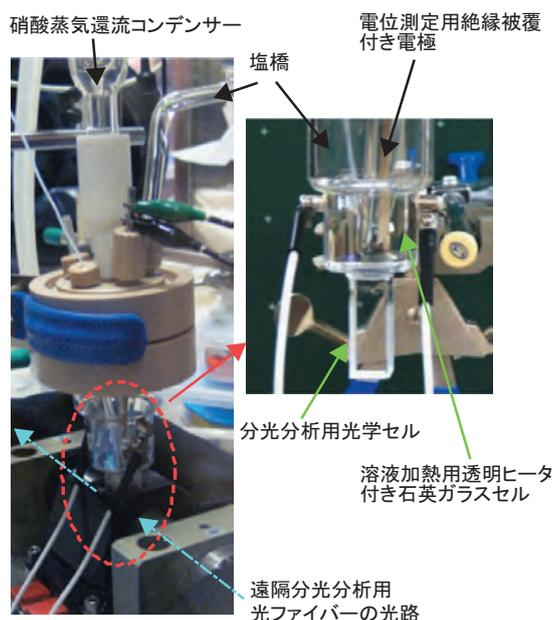
図 8-7 開発した分光分析機能を付加した電気化学試験セルの外観
