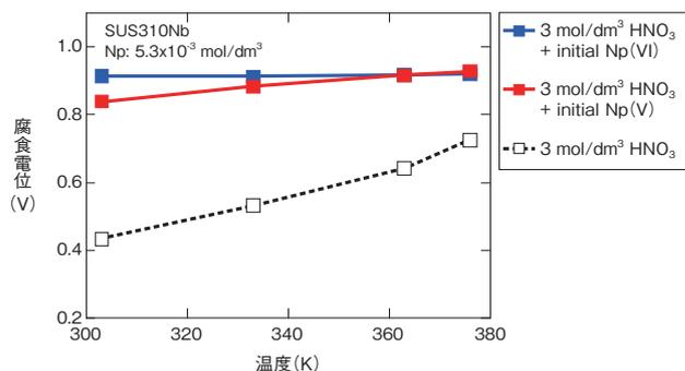
図 8-8 ステンレス鋼(SUS310Nb)の腐食電位に及ぼす温度の影響
