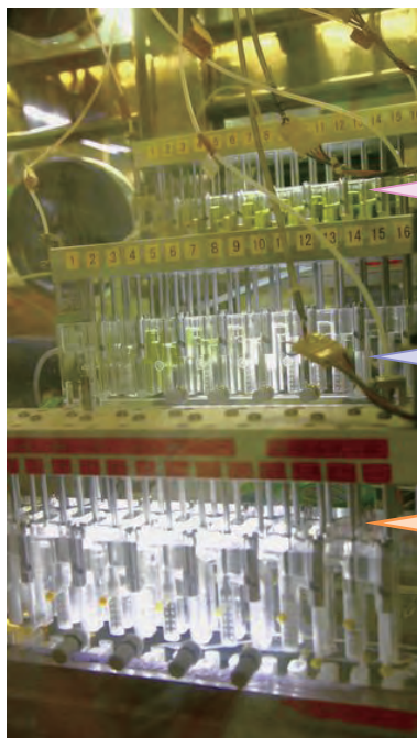
図 8-15 ミキサーセトラ型抽出器を用いた U 及び Pu の連続抽出試験の様子 グローブボックス内に設置したミキサーセトラ型抽出器を使用して、DEHBA の U 及び Pu に対する抽出特性を把握しました。
