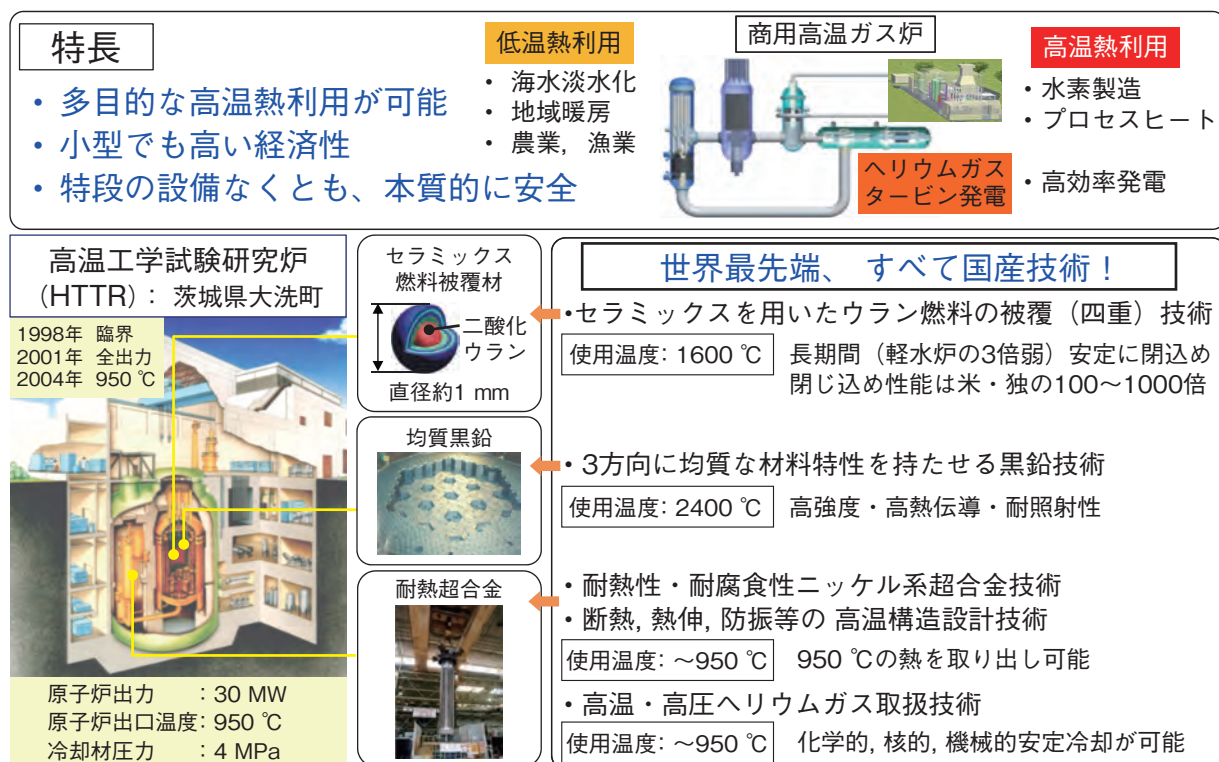
図9-1 高温ガス炉の概要：特長，利用，HTTRの主要仕様及び主要技術
