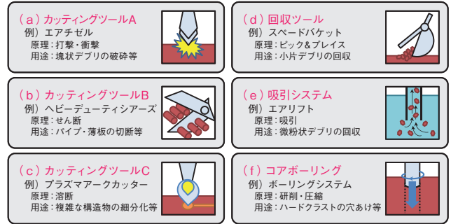
図1-28 取出し装置の分類 TMI-2で利用された装置類をその原理によって6種類に分類できます。TMI-2ではこれらの装置を用途(対象となるデブリの特徴)によって使い分けられました。
