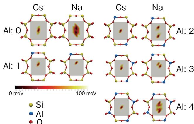
図 1-41 ゼオライトの Cs<sup>+</sup> 吸着部分での吸着エネルギーの分布
