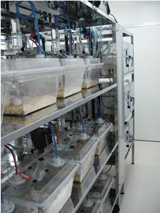
図 13-24 ラドン吸入試験設備
