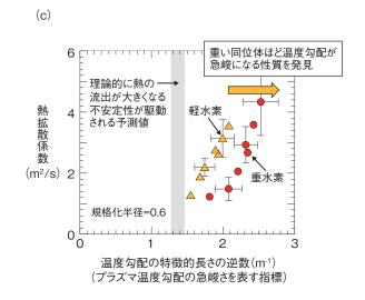
図 4-25 軽・重水素プラズマで熱拡散係数と温度勾配の急峻さを表す指標を比較 (a) は、軽・重水素放電で燃料プラズマの温度分布が全く同じになることを発見しました。(b) は、同じ温度分布を支えるのにあたって軽水素よりも重水素の方が約2倍程度熱を流出しにくい性質があることが分かりました。(c) は、プラズマの温度分布は、重い水素同位体ほどより急峻な勾配を得られる性質があることを解明しました。
