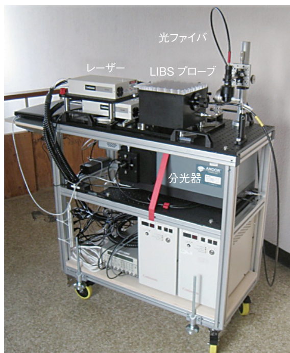
図1-25 可搬型ファイバ伝送 LIBS 装置試作機 レーザー、光ファイバ、LIBS プローブ、分光器から構成されます。大きさは 1.2 \times 1.5 \times 0.5 m、重量約 120 kg で、自由に移動できるようにコンパクトに設計しました。
