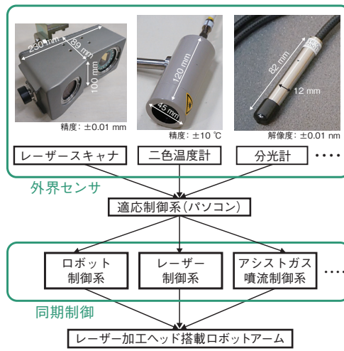
図1-28 適応制御システムブロック線図 外界センサ情報に基づき、ロボット、レーザー、ガス噴流を同期制御し、性能低下を防ぎます。
