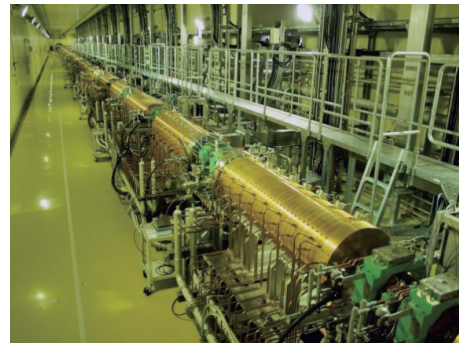
図5-1 リニアック後段の環状結合構造 (ACS) 空洞を用いた加速部
