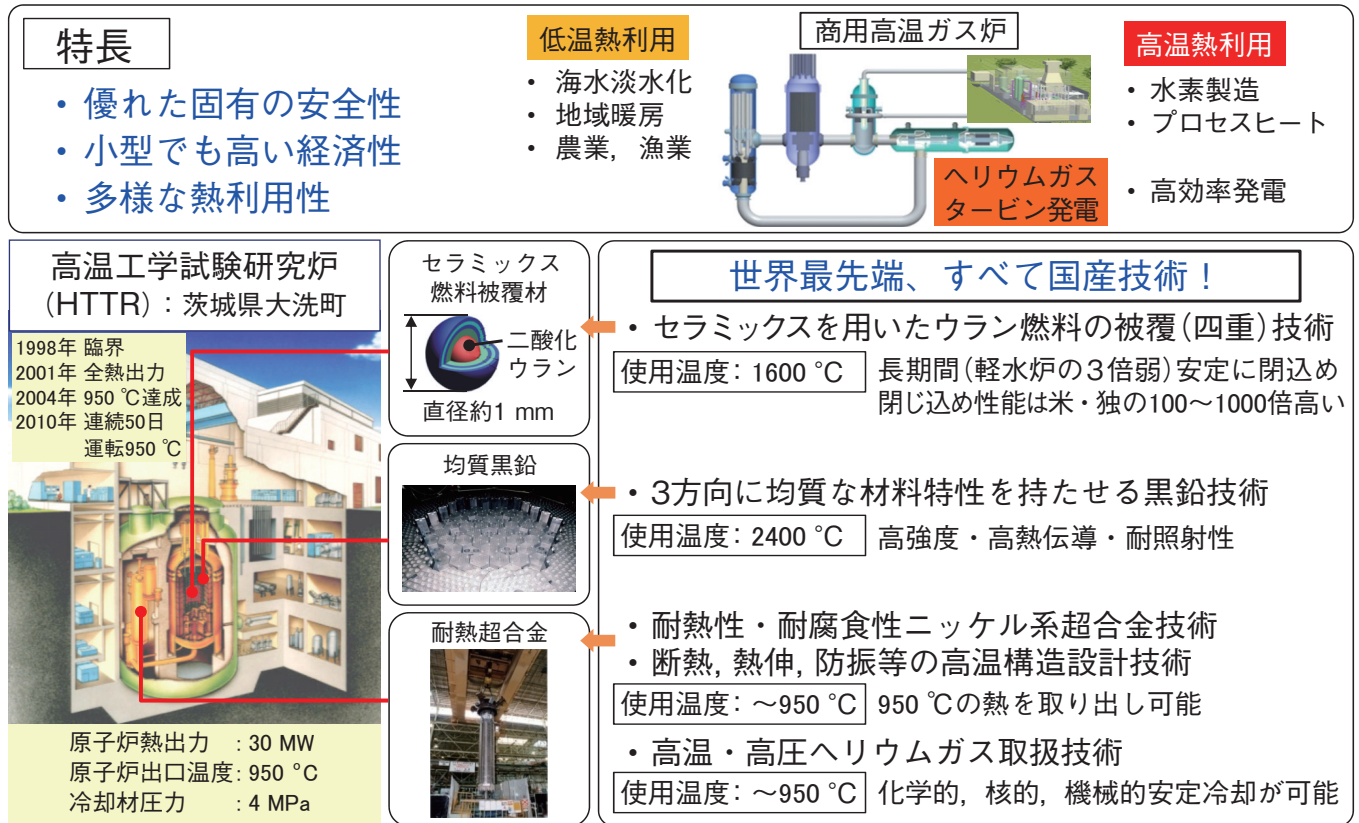
図6-1 高温ガス炉の概要：特長，利用，HTTRの主要な仕様及び技術
