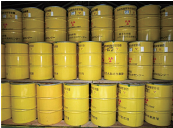
図 8-6 スラッジ、廃吸着剤等を保管しているドラム缶
