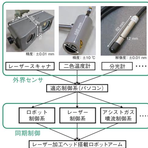
図1-28 適応制御システムブロック線図
