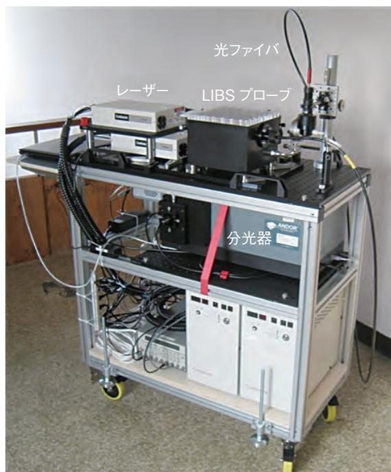
図1-25 可搬型ファイバ伝送 LIBS 装置試作機
