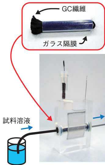
図 4-16 カラム電極を用いる流れ系電解法 グラッシーカーボン (GC) 繊維を作用電極とするカラム電極電解法では、多孔質ガラス隔膜に GC を充てんし (上図参照)、その GC の間に試料溶液を流しながら電解することにより、迅速かつ高効率に原子価を制御できます。
