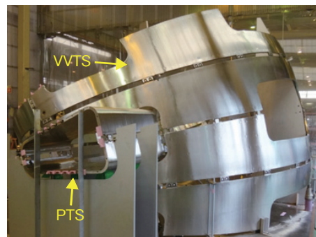
図9-15 VVTSの仮組み 実機製作した10度のVVTSを40度まで仮組みをして、製作寸法が寸法公差以内であることを確認しました。
