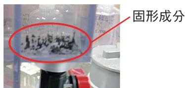
図4-16 除染廃液中の固形成分が除去される様子
