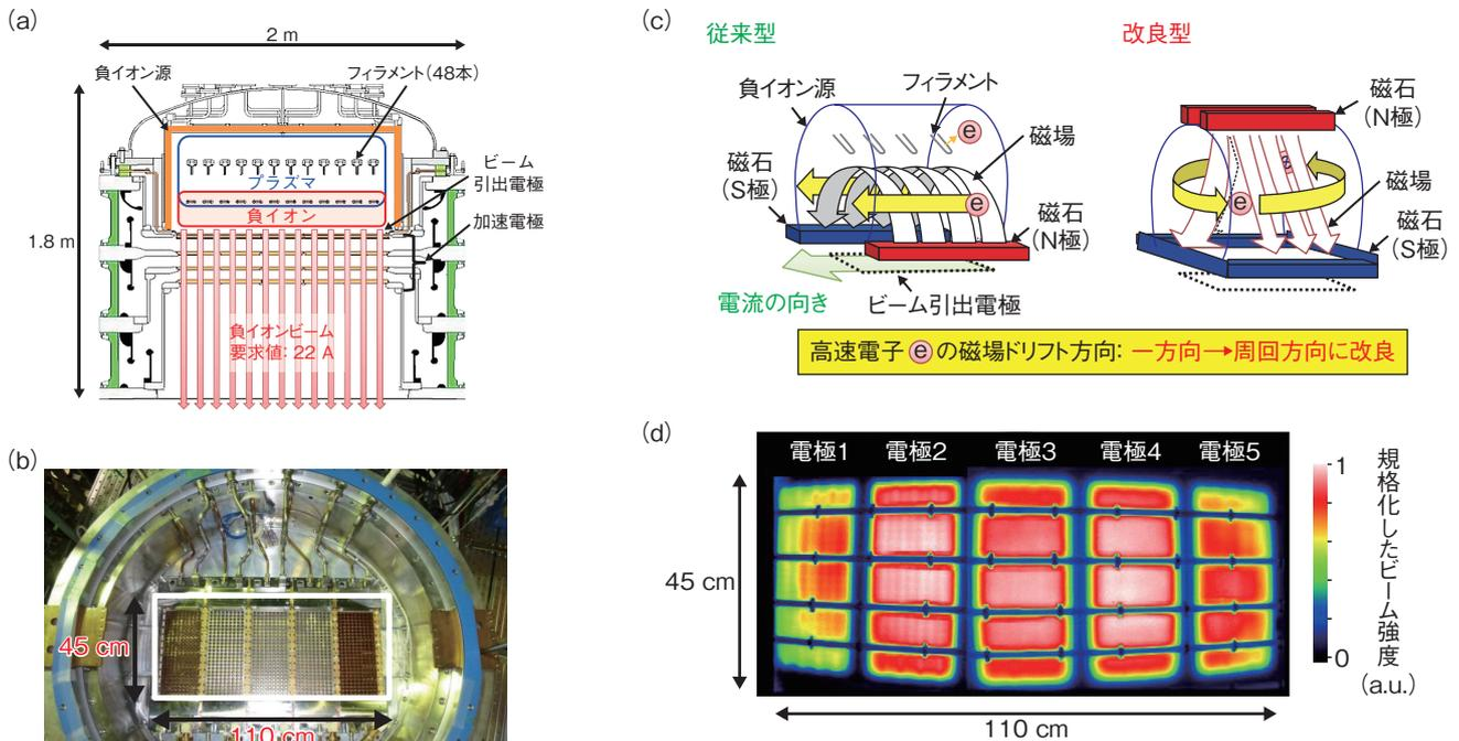
図9-11 JT-60 負イオン源の断面図と引出電極
