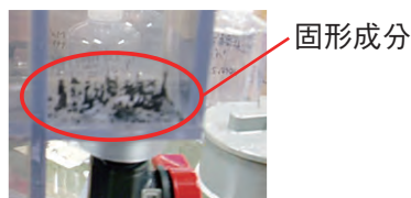
図4-16 除染廃液中の固形成分が除去される様子 水の中に浮遊している固形成分が液液界面に吸着されることにより、除染廃液中の固形成分が回収・除去されます。
