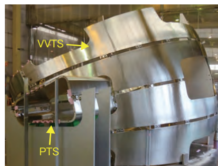
図9-15 VVTSの仮組み 実機製作した10度のVVTSを40度まで仮組みをして、製作寸法が寸法公差以内であることを確認しました。
