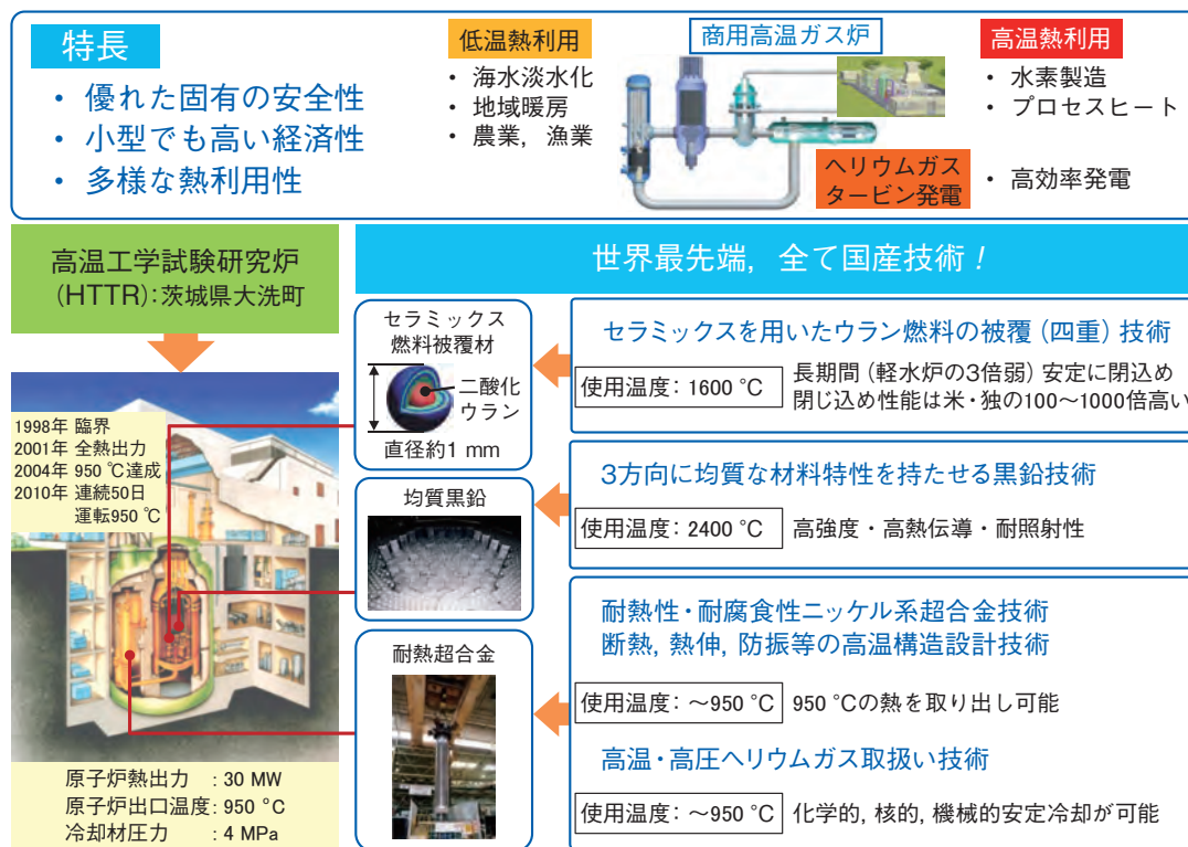
図6-1 高温ガス炉の概要：特長，利用，HTTRの主要仕様及び主要技術
