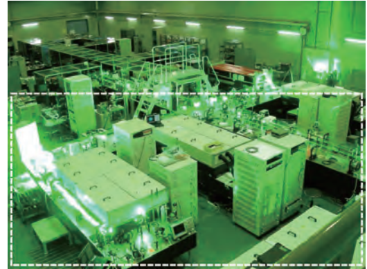
図5-3 高強度レーザー装置(J-KAREN) 破線部は新規に導入した部分を示しています。
