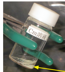
図4-14 調製したCmシュウ酸塩分離精製したCm溶液にシュウ酸を添加し、約10mgのCmシュウ酸塩を調製しました。
