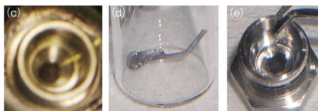
図 4-29 試験で得られた Am 化合物及び合金試料の外観
