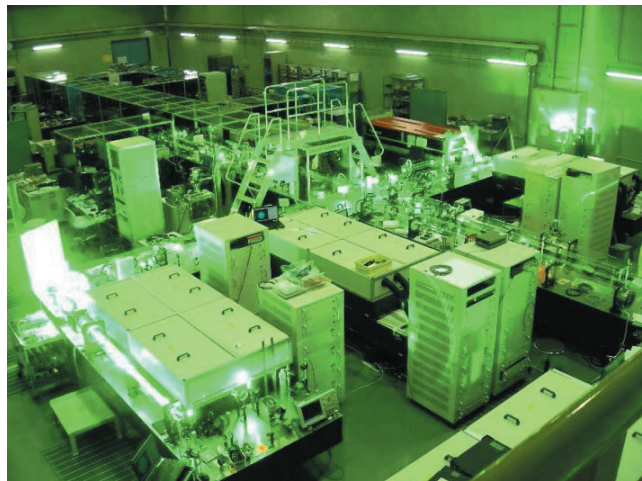
図 5-3 高度化調整中の J-KAREN-P レーザー 0.1 Hz の高繰り返し動作で世界トップクラスの 1 PW のピークパワーを実現します。
