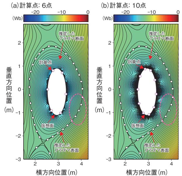
図9-11 プラズマ形状推定システムが推定したプラズマ断面形状
