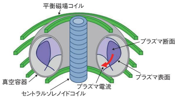
図9-10 トカマクプラズマ（ドーナツ型）の概念図
