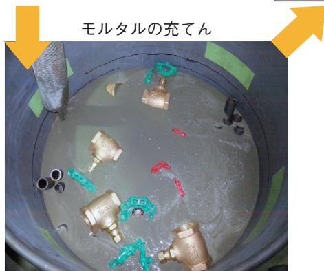
図 8-8 模擬廃棄物の組成，セメントの充てん，硬化後の空隙率
