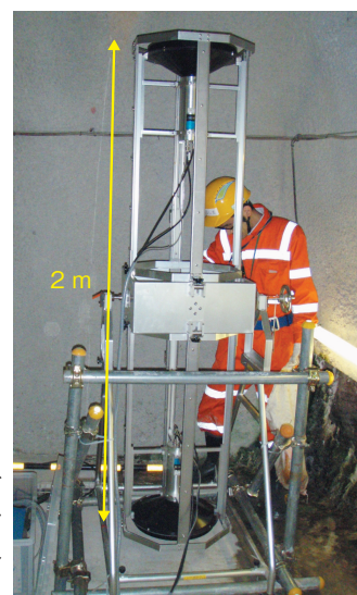
図 8-14 ミュオン測定装置 上下に二つの検出部（シンチレータ）があり、上方から飛来したミュオンを対象とするため、二つの検出部を同時に通過したミュオンのみを計測しました。
