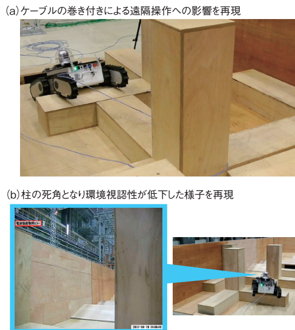
図1-23 遠隔操作ロボットを用いた試験走行による検証 遠隔操作ロボットの走行により、分析で得られたケーブルの巻き付きや環境視認性の課題を再現しました。
