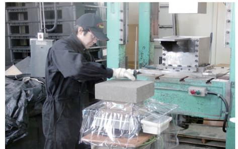
図 8-15 埋め戻し材ブロックの製作
