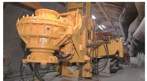
図 8-14 自走式大口徑掘削機
