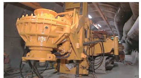
図 8-14 自走式大口径掘削機 直径 2.4 m、深さ 4.5 m の試験孔の掘削が可能です。
