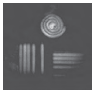
図 7-11 水中において超音波により取得した画像 改良を加えた送信センサ及び受信センサにより、ターゲットから 800 mm 離れた位置から鮮明な画像を得ました。
