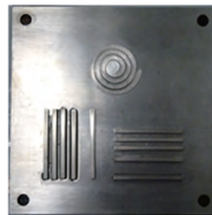
図 7-10 画像化ターゲット 直線ターゲットは線幅 3 mm で、線間隔は 3、5、10 mm としました。螺旋ターゲットは線幅 4 mm で、1 段あたり 2 mm 高さとなりました。
