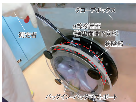
図 1-16 設備の測定の様子
