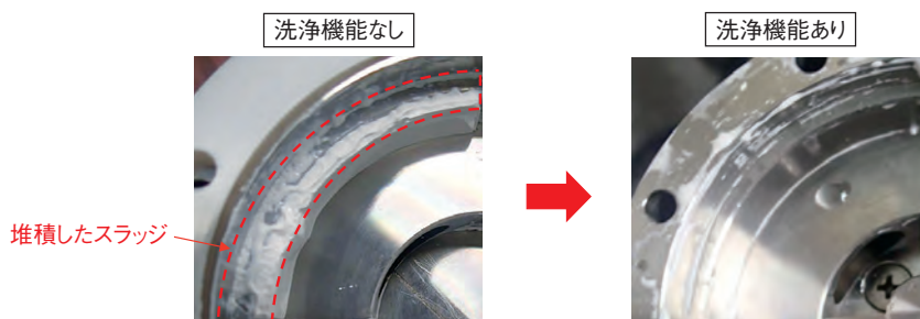
図 7-16 洗浄機能追加による効果（ロータ内の上部）
