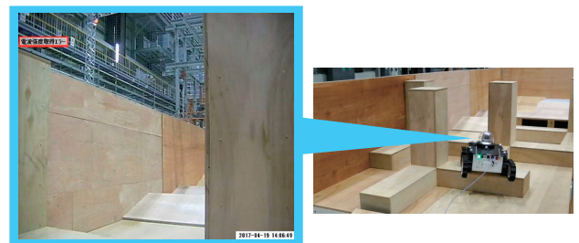
図 1-23 遠隔操作ロボットを用いた試験走行による検証 遠隔操作ロボットの走行により、分析で得られたケーブルの巻き付きや環境視認性の課題を再現しました。
