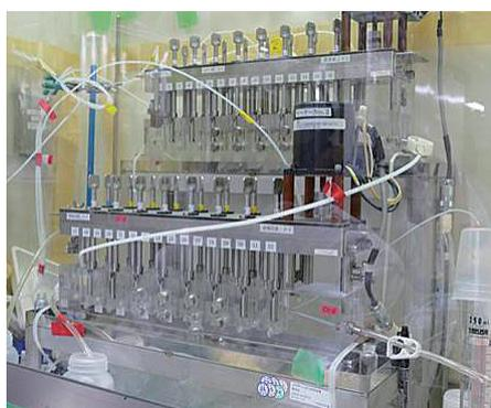
図4-4 フード内のミキサセトラ装置
