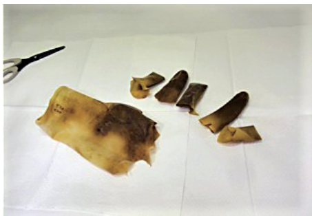
図 8-7 廃棄物から採取した可燃物試料の例 容器に収納された廃棄物の中から、ゴム手袋を試料として採取し裁断しました。
