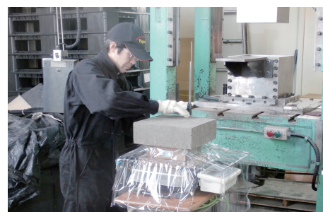
図 8-15 埋め戻し材ブロックの製作 本試験では、人力による設置としたため、30 cm × 30 cm × 10 cm、重量約 16 kg のブロックとしました。奥に見える 80 t プレス機にて圧縮成型して製作しました。
