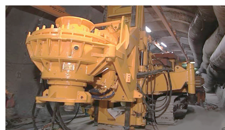
図 8-14 自走式大口徑掘削機 直径 2.4 m、深さ 4.5 m の試験孔の掘削が可能です。
