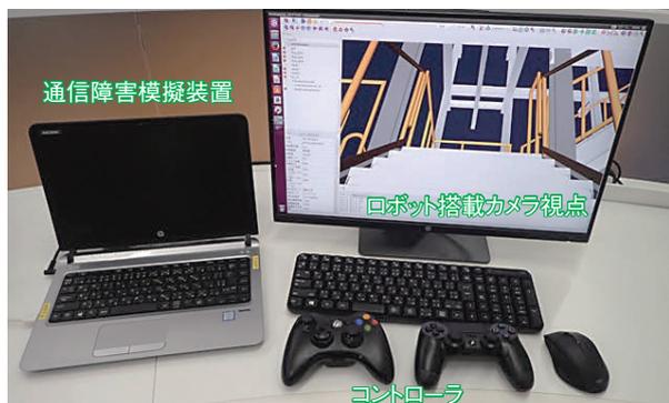
図1-21 開発したロボットシミュレータ
