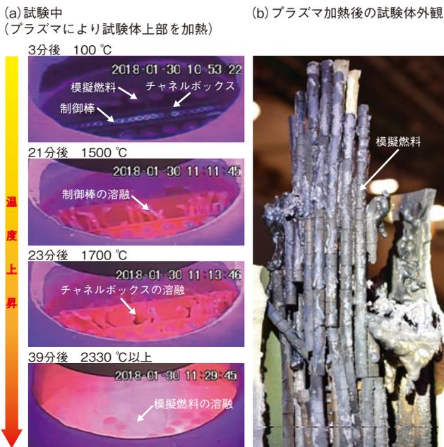
図1-2 模擬燃料集合体破損試験
