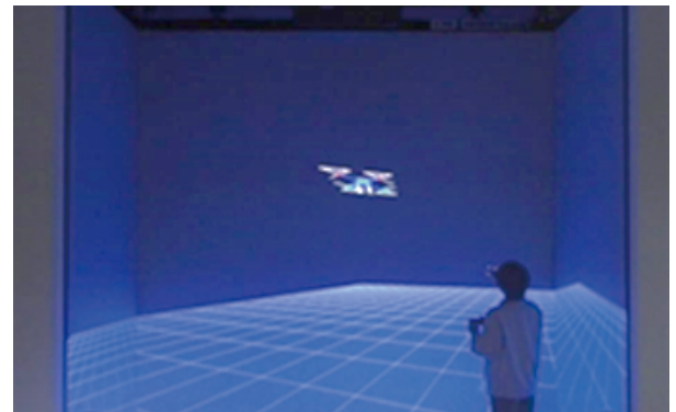
図 1-26 目視による仮想操縦訓練の例 没入型バーチャルリアリティシステムを利用した目視によるドローンの操縦訓練を行った例を示しています。
