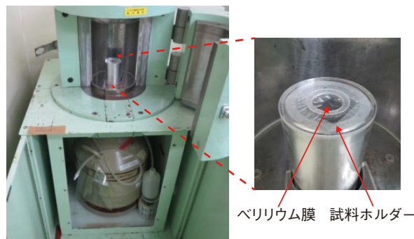
図1-20 低エネルギー光子検出器 (Ge-LEPS) 検出器入射窓は薄いベリリウム膜であり、低エネルギーの光子 ( \gamma 線) を高効率で測定可能です。
