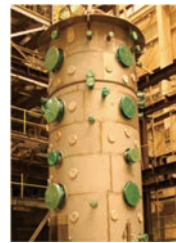
図2-2 大型格納容器試験装置（CIGMA）の概要 事故時の高温高圧の蒸気や水素の挙動並びに種々の事故拡大防止策を模擬できるように設計されています。
