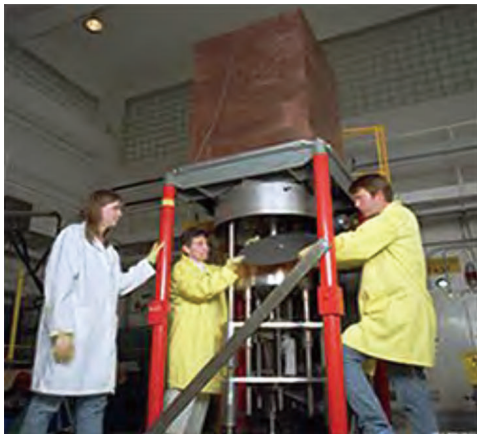
図4-15 臨界実験装置 COMET の外観図 米国の National Criticality Experiments Research Center (NCERC) にある COMET の外観図を示します ( https://www.nnss.gov/pages/facilities/NCERC.html )。
