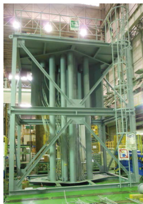
図7-3 ACS モックアップ 1/3 炉心を対象としてモックアップにより配管配置及び施工性について確認し、設計製作に係る知見を獲得しました。
