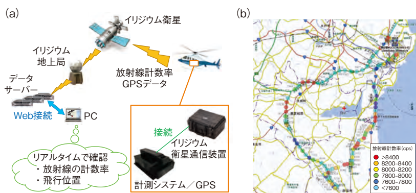
図2-18 リアルタイムに航空機モニタリングデータを共有する通信システム
