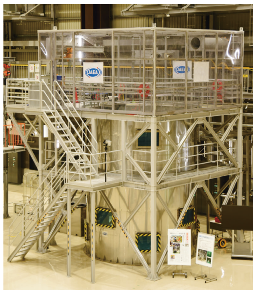
図1-8 ロボット試験用水槽
