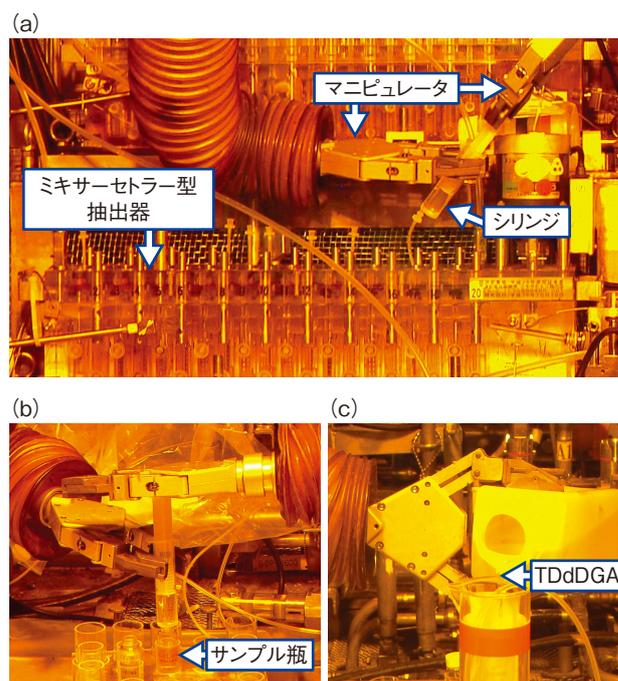
図4-14  $\alpha\gamma$ セル内での MA と希土類元素の一括回収試験の様子
